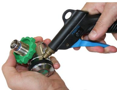
2. Verbleibende Feuchtigkeit mit einer Druckluftpistole aus dem Druckminderer ausblasen. Den Druckminderer über die Lüftungsbohrungen ausblasen. Druckluft mit Atemluftqualität nach EN 12021 verwenden. Eine der Bohrungen muss nach unten zeigen. Gründlich ausblasen und vollständig trocknen lassen.
